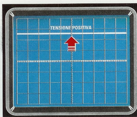
Fig.22 Ottenuta la condizione riportata in fig.21 potete spostare il selettore sulla posizione DC e se vedete che la traccia orizzontale si sposta verso l'alto potete essere certi che la tensione applicata sul puntale è di polarità Positiva.
