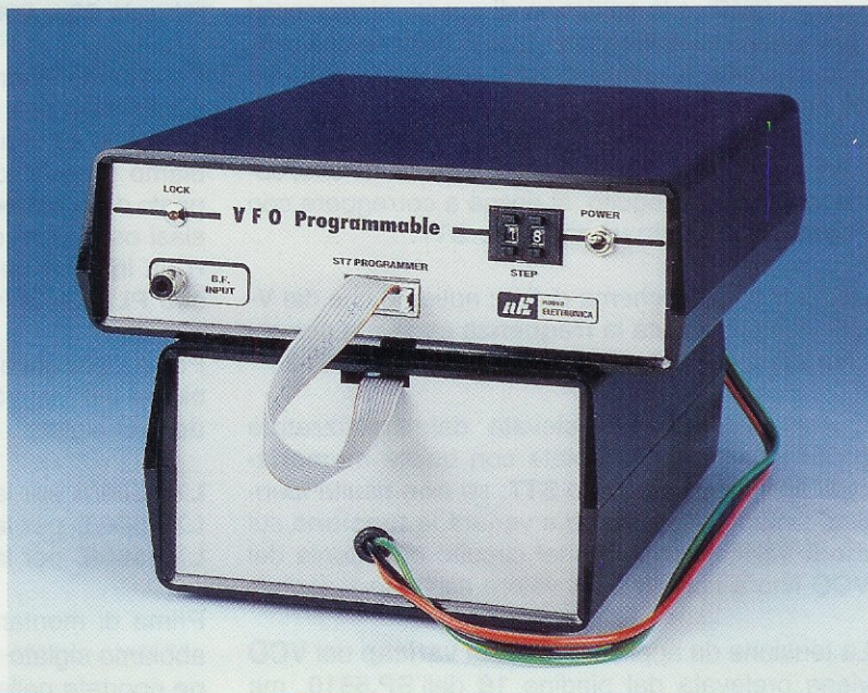
Fig.6 Sul pannello frontale del VFO programmabile è presente un connettore a vaschetta che va collegato al programmatore LX.1546 e all'alimentatore siglato LX.1203 (vedi foto in fig.4) tramite una piattina cablata (PT 10.30) che vi verrà fornita quando ordinerete il kit LX.1565.
